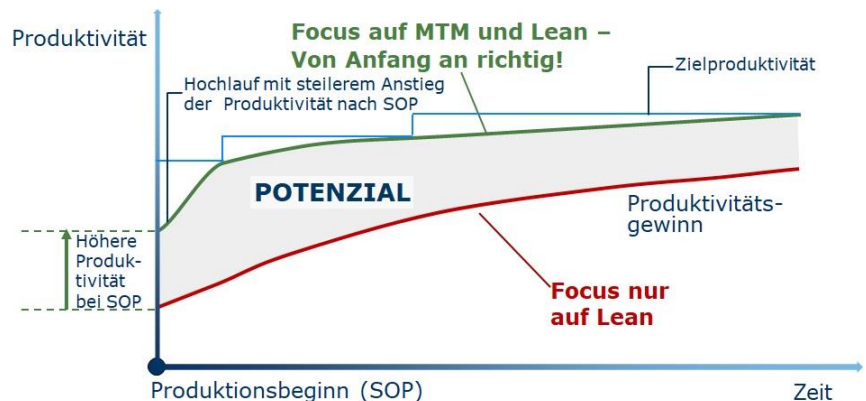
Bild 2 Produktivität – MTM und Lean. Durch die Kombination von Lean und MTM wird die geplante Produktivität in wesentlich kürzerer Zeit erreicht.
